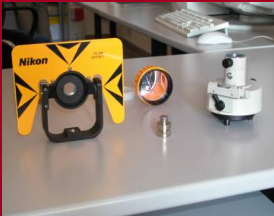
I componenti smontati: da sinistra: Porta-prisma, prisma, perno di fissaggio, base
