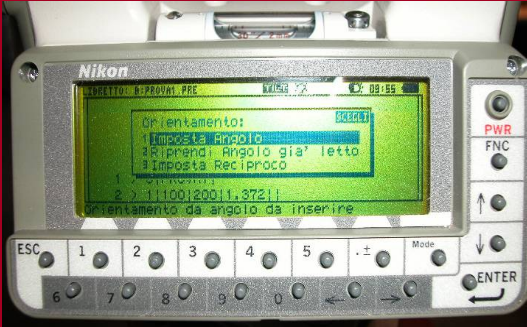
Impostazione dell'angolo di orientamento per la definizione del piano verticale di riferimento
