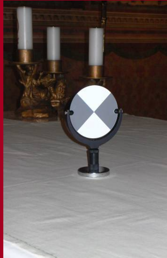
target utilizzato per la fusione (registrazione) delle diverse scansioni
